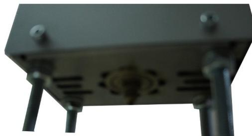
Для закрепления литевой формы предусмотрена прижимная пластина. Расстояние от пластины до литника и усилие прижима формы регулируется барашковыми гайками.
