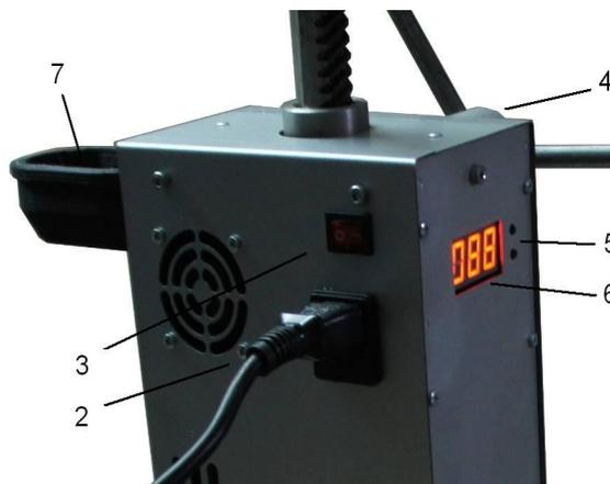
На противоположной стенке находится рукоятка (4) перемещения плунжера. Благодаря разнесению органов управления и вращающегося механизма, вероятность повреждения шнура питания минимальна.
